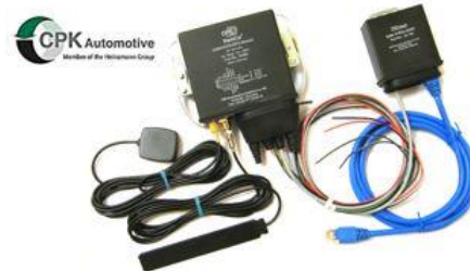
شکل ۱۳. دستگاه داده‌بردار استفاده شده در پروژه‌ی "امکان‌سنجی نصب فیلترهای جاذب دوده بر روی اتوبوس‌های شهر تهران"
